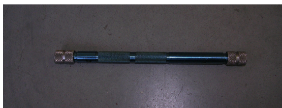
4: Odberová oceľová trubička so sorbentom Tanax TA
