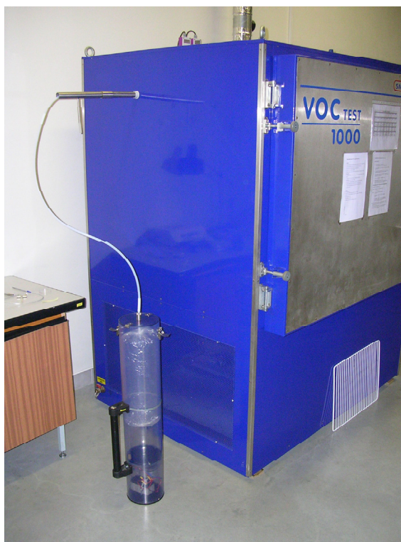
1: Odberová nádoba s odberovým vakom a malopriestorová komora
