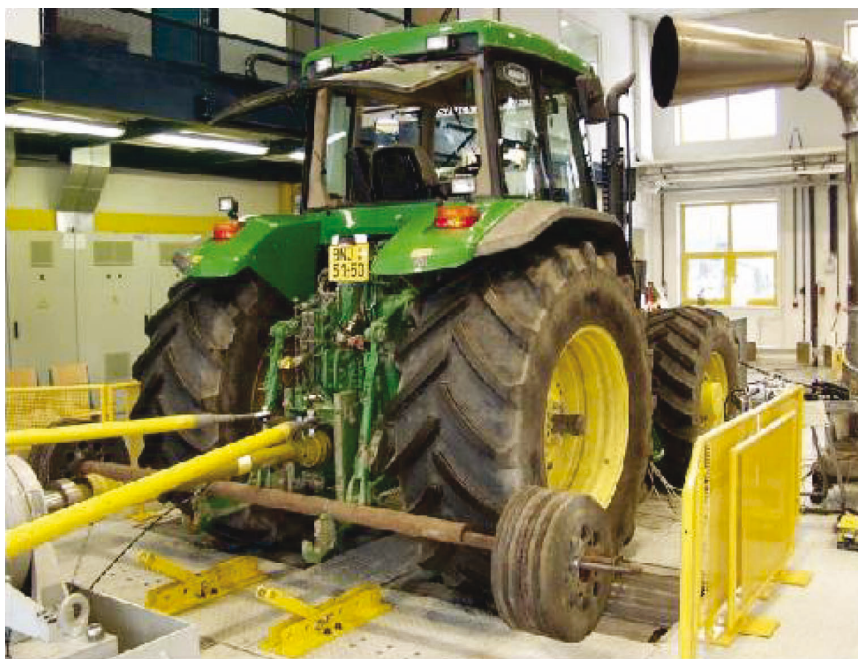
2: Dotížení traktoru pomocným závažím
