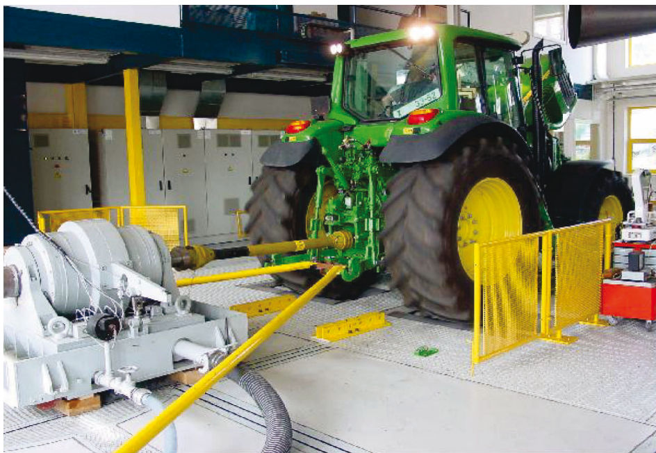
1: Elektrovířivý dynamometr VD 500 a válcový dynamometr 4VDM E-120-D
