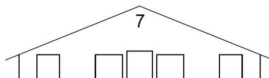
2: Umístění sedmého čidla v hřebeni stáje
